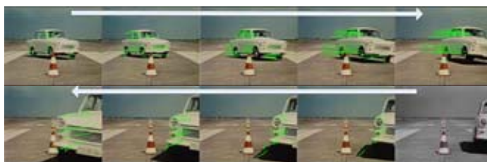
图 1 使用 Harris 和 KLT 算法产生的视频轨迹，黑白帧表示亚镜头分割处即轨迹断开处
